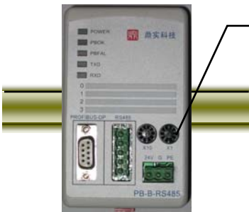
图 2-13 PROFIBUS 地址设置开关 SA
