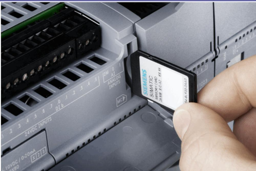
图 2：插入存储卡
